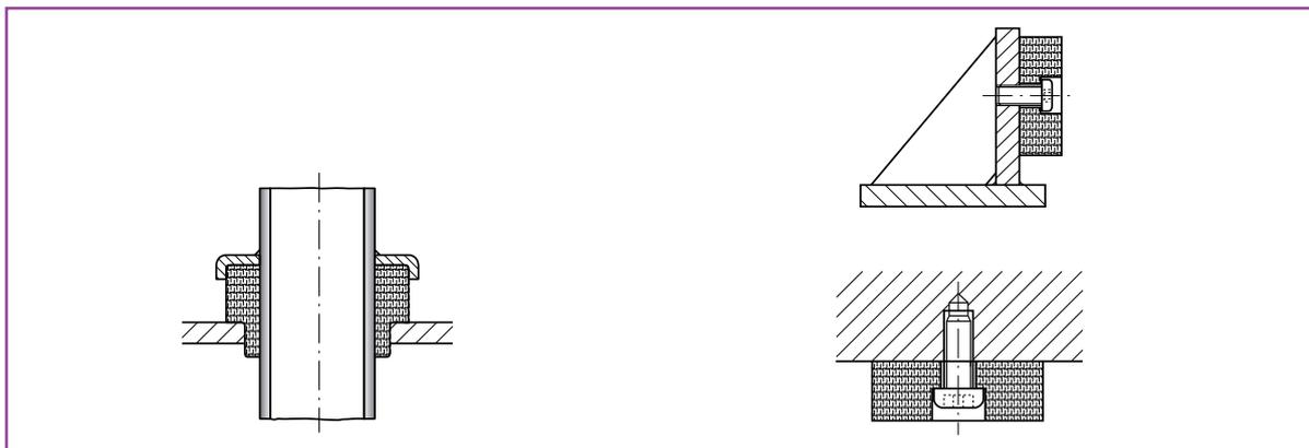
Desacoplamiento de tubería
