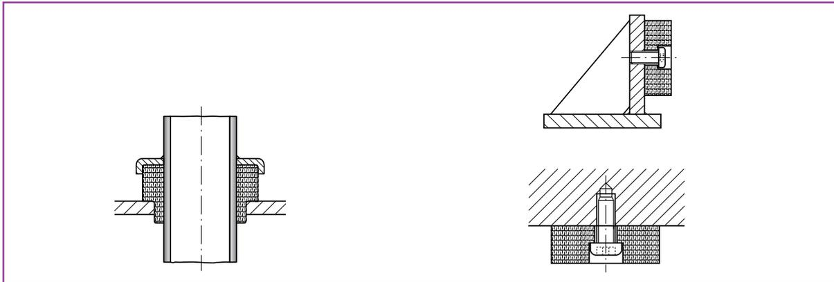
Desacoplamiento de tubería
