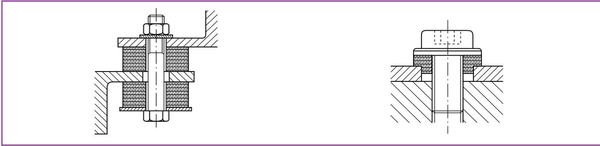
Suspensiones de cajas de cambios, motores, ventiladores, bombas (rigidez lateral muy baja)
